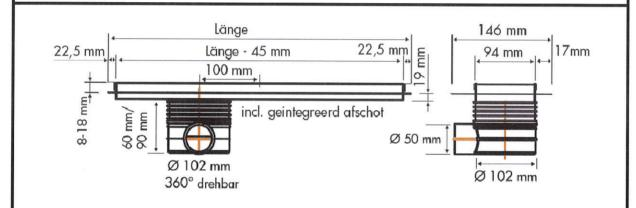
"Easy Drain Multi TAF, Artikel-Nr.: EDMTAF 500 bis 2000" mit "Schallschutzelement, Artikel-Nr.: ED-SCHALL", der Firma ESS
