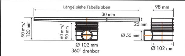
"Easy Drain Fliesenrinne, Artikel-Nr.: EDT 500 bis 2000" mit "Schallschutzelement, Artikel-Nr.: ED-SCHALL", der Firma ESS
