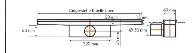
"Easy Drain Compact 50, Artikel-Nr.: EDCOM 500 bis 1200 -50 und 50 D", "Easy Drain Compact 50 Zero, Artikel-Nr.: EDCOMZ 700 bis 1000 -50", "Easy Drain Compact 50 FF, Artikel-Nr.: EDCOMFF 500 bis 1200 -50" und "Easy Drain Compact 50 FF Zero, Artikel-Nr.: EDCOMFFZ 700 bis 1200 -50" mit "Schallschutzelement, Artikel-Nr.: ED-SCHALL", der Firma ESS
